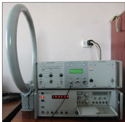
Рис. 9. Внешний вид системы для исследования ионосферных вариаций фазы и амплитуды сигнала станции РБУ службы эталонных сигналов частоты и времени. Верхний прибор — приемник ПК-66 с магнитной антенной (слева) и микроконтроллерным измерителем фазы; нижний — рубидиевый стандарт частоты Ч1-69
